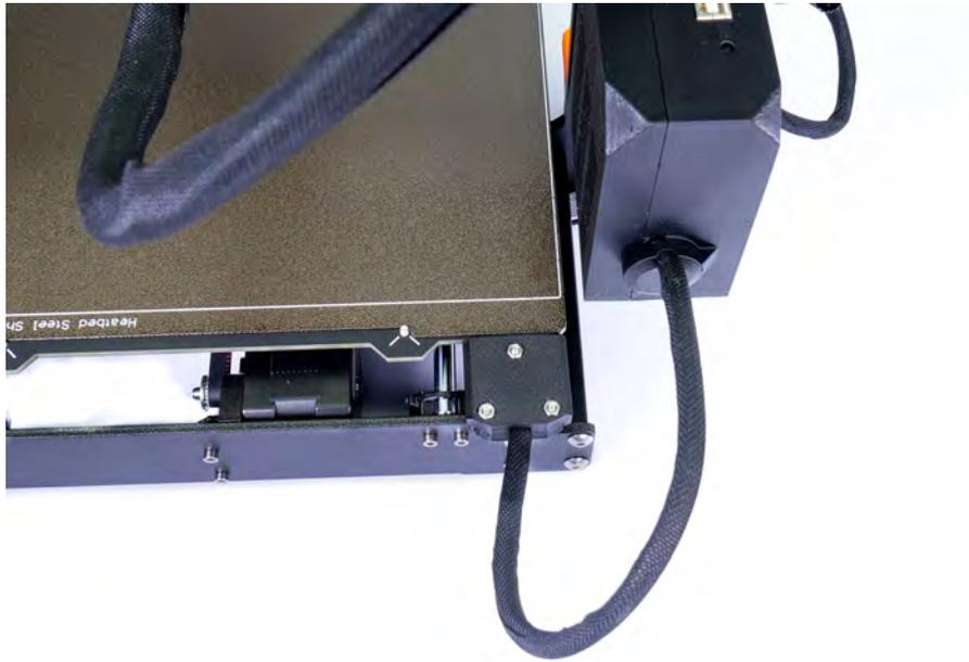
*Image 49 - Les câbles doivent être enveloppés dans une gaine textile*
