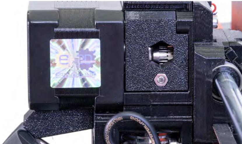
Image 40 - Nettoyage de l'extrudeur - vous pouvez voir la poulie dentée à travers le trou de service
