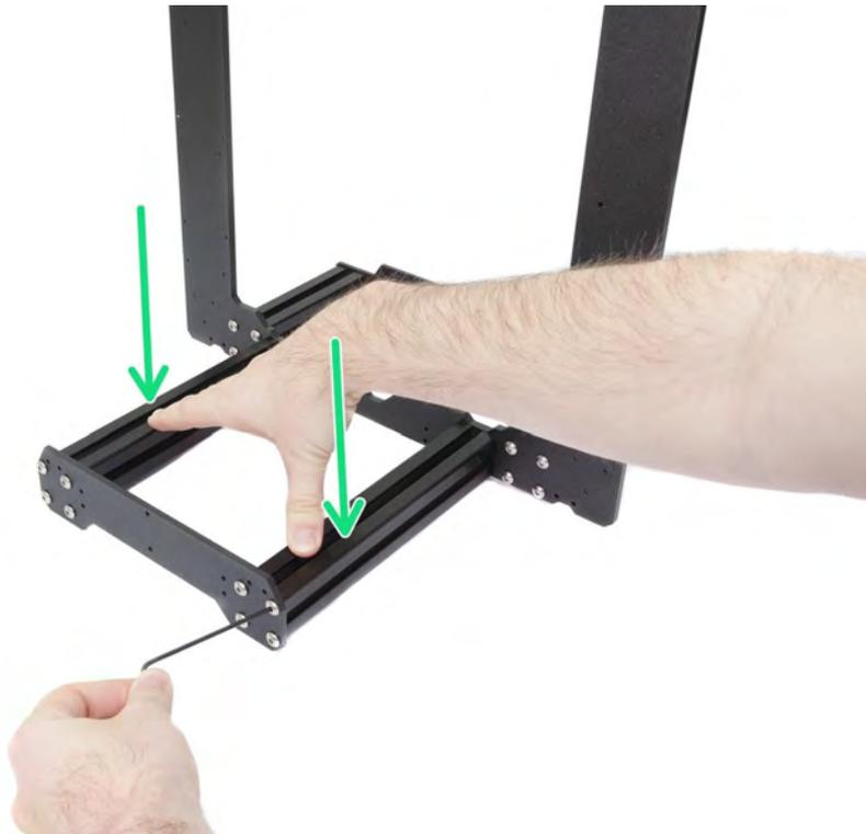
*Image 45 - Comment serrer correctement ensemble le cadre, les platines et les extrusions.*
