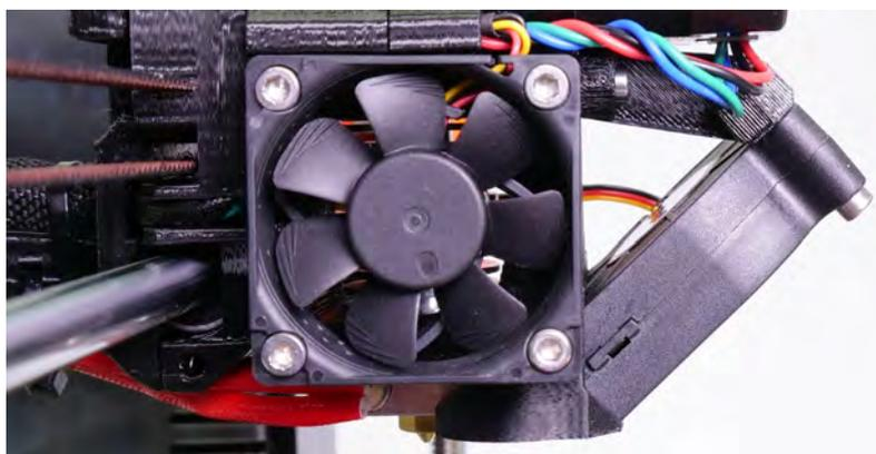
Image 36 - Ventilateur de refroidissement de la buse
