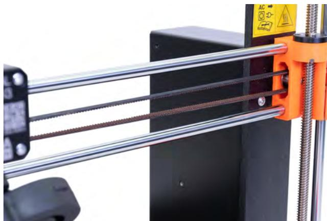
*Image 48 - Une courroie axe-X correctement tendue*
