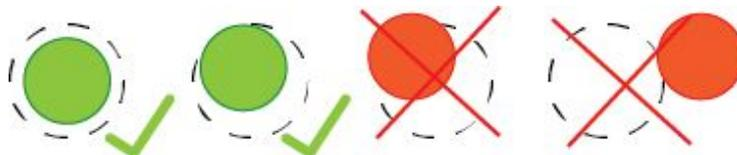
*Immagine 6 – la sonda deve essere dentro i cerchi (il 1° e il 9° punto di calibrazione) per livellare correttamente il piano di stampa.*
