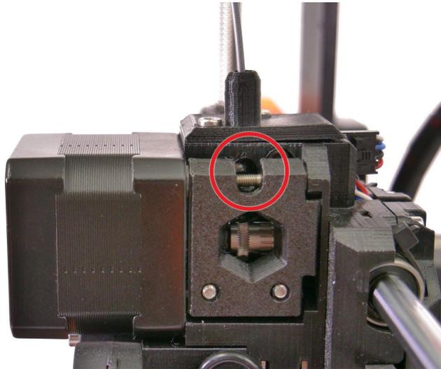
*Bild 40 - Zugangsöffnung für die Reinigung des Filamentsensors*
