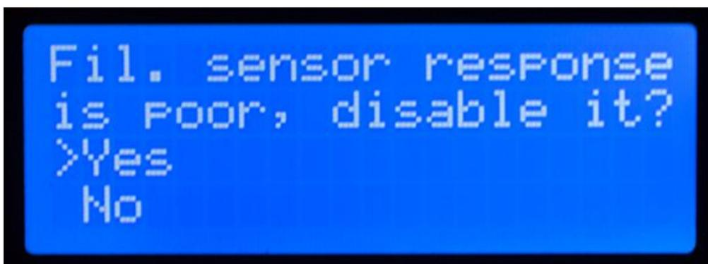
Bild 38 - Informationen über die Filamentqualität (Filament Sensor Engine 2.0)
