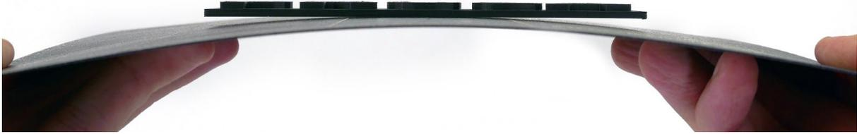
Bild 14 - Entfernen eines Modells von der PEI-Oberfläche durch Biegen der Federstahlplatte
