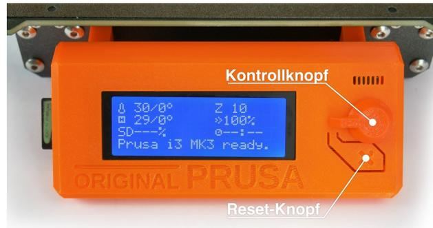
Bild 16 - LCD-Anzeige und Kontrollknöpfe
